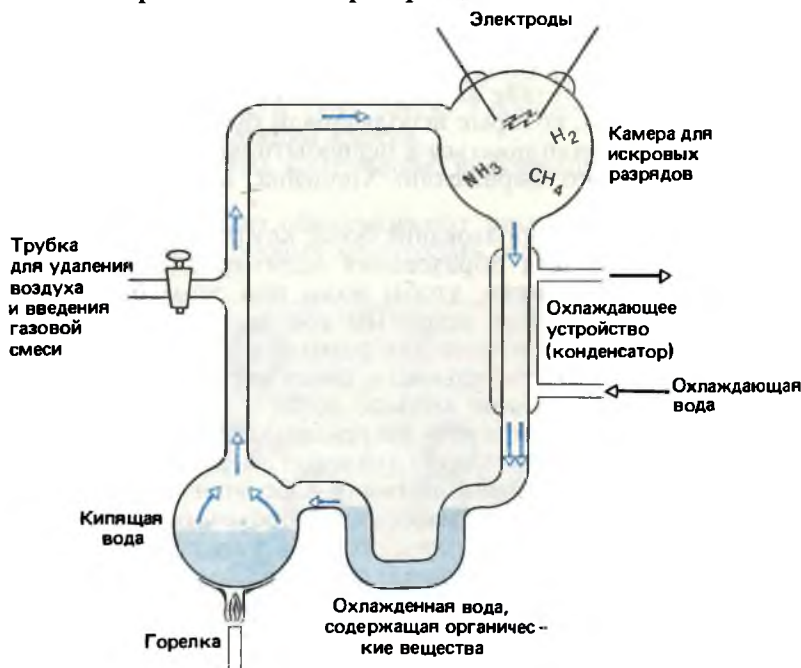
Рис. 13.4. Прибор, использованный Миллером для воспроизведения условий, существовавших на первобытной Земле. Стеклоный шар величиной с футбольный мяч содержит «атмосферу» — смесь аммиака ( NH_3 ), метана ( CH_4 ) и газообразного водорода ( H_2 ). Искровые разряды между электродами имитируют молнии — ис-
